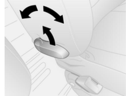
Hebel ziehen, Neigung einstellen und Hebel loslassen. Die Rückenlehne muss einrasten. Zum Einstellen Rückenlehne entlasten.
