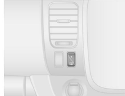
Die Heizung wird durch Drücken der Taste
