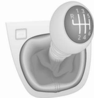
Rückwärtsgang: Nach Betätigung des Kupplungspedals bei stehendem Fahrzeug 3 Sekunden warten, anschließend Ring am Schalthebel nach oben ziehen und Gang einlegen.
