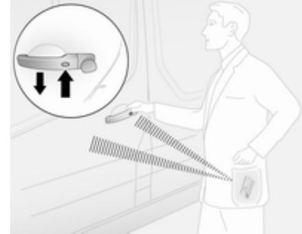
Die Taste auf jedem Türaußengriff drücken, wenn sich der elektronische Schlüssel im Bereich des Erfassungsbereichs befindet (ca. ein Meter von den vorderen Türen oder dem Laderaum) und den Handgriff zum Öffnen ziehen.
